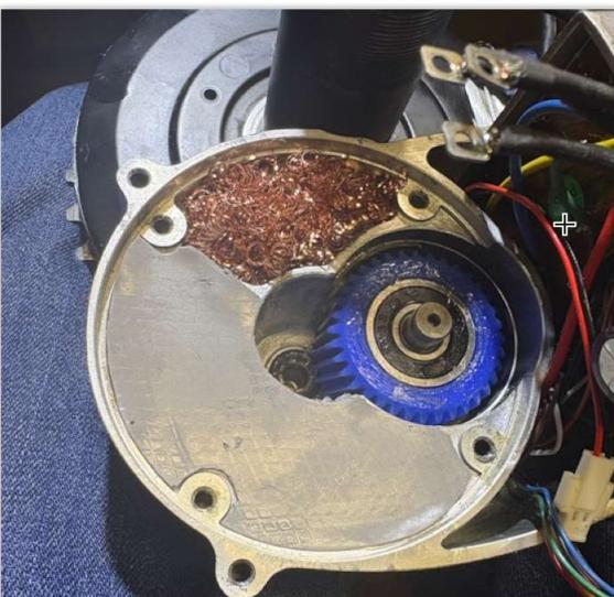
4) Preparo una "coperta" termoconduttiva con rete di rame e nastro di rame e l'avvolgo intorno al motore. Questo tipo di soluzione mi fornisce un certo effetto elastico che migliora la conduzione tra statore e copertura dello stesso. Fisso la "coperta con un giro di filo di rame.
