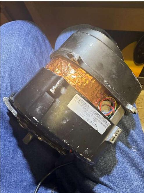
8) Installo una PT1000 a bassa inerzia termica (in parole povere con sensore molto piccolo) tra statore e "coperta" termica che poi mi serve per leggere dove si va con le temperature.
