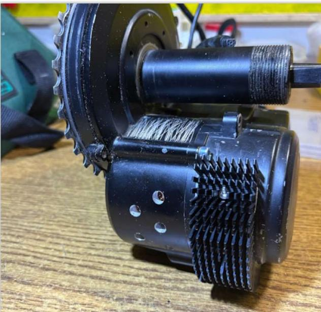
10) Foro camera esterna inutilizzata (dove escono i cavi dal controllore) e ci metto lana di rame. Foro anche la copertura di plastica per permettere un minimo di flusso di aria (e lo scolo di eventuale acqua).
